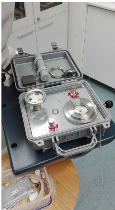
Prvotní způsob testování, tlakový píst, využití vzduchu (foto: archiv autora).
