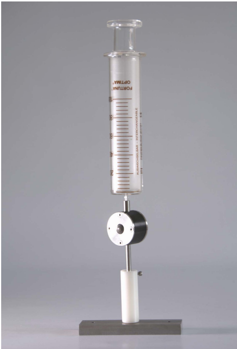
Prototyp univerzálního modelového oka pro metrologicky objektivní kontrolu bezkontaktních očních tonometrů (foto: archiv autora).
