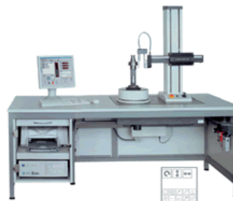
Profilomer Hommel Tester Form 1004/350 Umožňuje súčasné meranie drsnosti povrchu, profilu a topografie. Merací rozsah zvislej osi 350 mm, prestavenie vodorovnej osi 170 mm Maximálny merací priemer 300 mm Priemer rotačného stola 150 mm Maximálna hmotnosť súčiastky 25 kg
