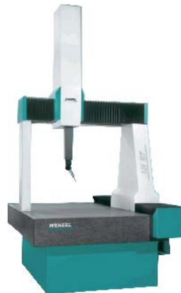
Súradnicový merací stroj Wenzel LH 87 CNC Premium Merací rozsah (mm): X = 800, Y = 1 500, Z = 700 Maximálna hmotnosť súčiastky: 1 000 kg Maximálna chyba merania v priestore: MPE_E = (1,5 + L/450) \mu\text{m} Rozlišovacia schopnosť: 0,1 \mu\text{m}
