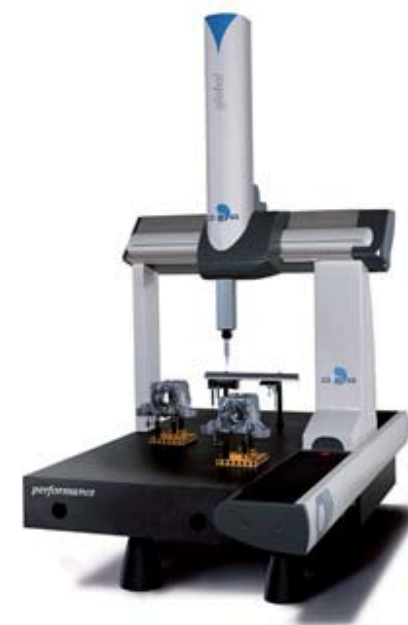
Súradnicový merací stroj DEA Global Performance 12.22.10 Merací rozsah (mm): X = 1 200, Y = 2 200, Z = 1000 Maximálna hmotnosť súčiastky: 2 250 kg Maximálna chyba merania v priestore: MPE_E = (2,5 + L/333) \mu\text{m} Rozlišovacia schopnosť: 0,039 \mu\text{m}
