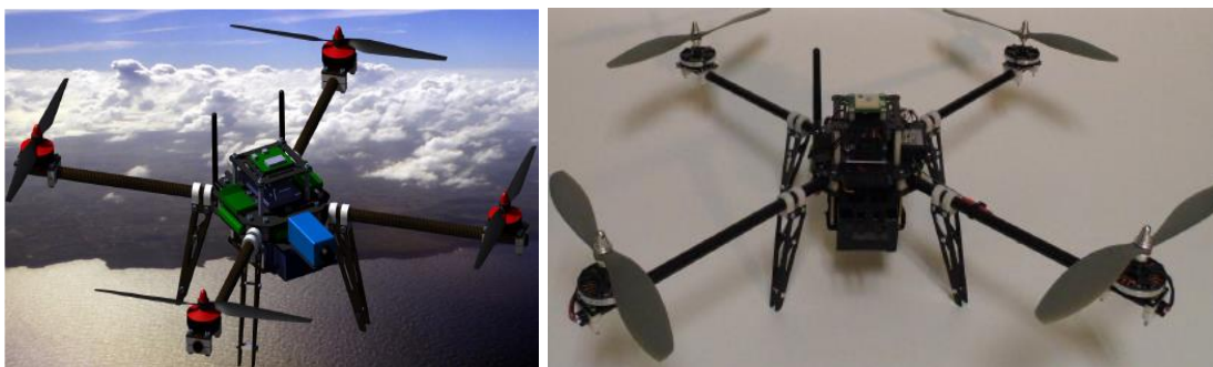
Konštrukčný návrh kvadrikoptéry a jej fyzické prevedenie
