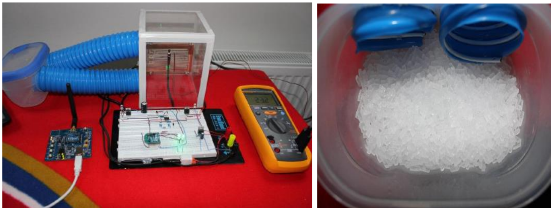
Pracovisko pre bezdrôtovú reguláciu teploty v miestnosti na báze XBee a teplotného snímača LM35CZ a nádoba so suchým ľadom
