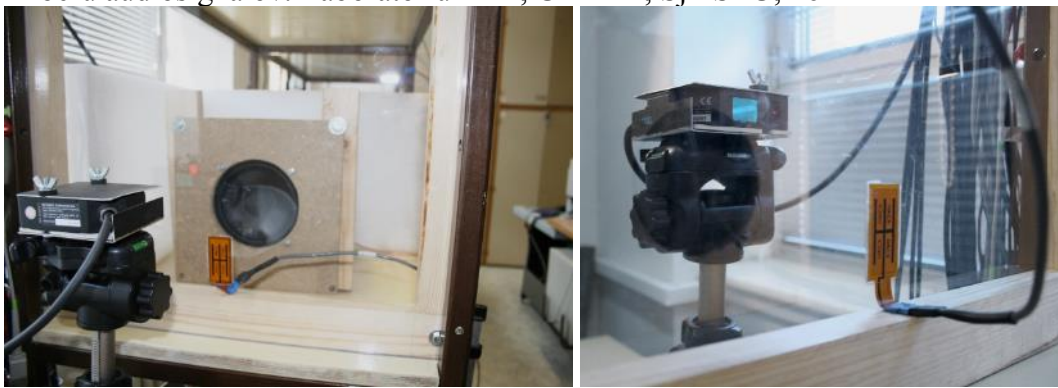
10. Experimentálna laboratórna zostava na skúmanie aktívneho blokovania optického zberu audiosignálov. Laboratórium L2, ÚAMAI, Sjf STU, 2012
