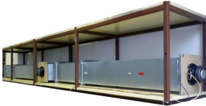
10. Experimentálna laboratórna zostava na skúmanie aktívneho blokovania optického zberu audiosignálov. Laboratórium L2, ÚAMAI, Sjf STU, 2012
